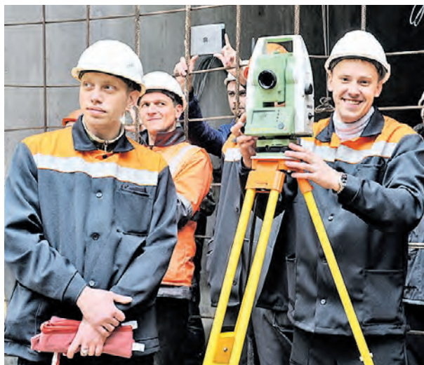
► Вчера, 9:58. Рабочий Евгений Климов (справа) использует тахеометр, чтобы определить отклонение шита от заданной траектории
