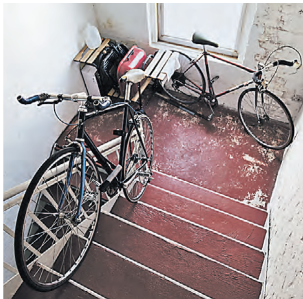
Хранение велосипедов и других вещей в подъездах жилых многоквартирных домов нарушает правила пожарной безопасности
