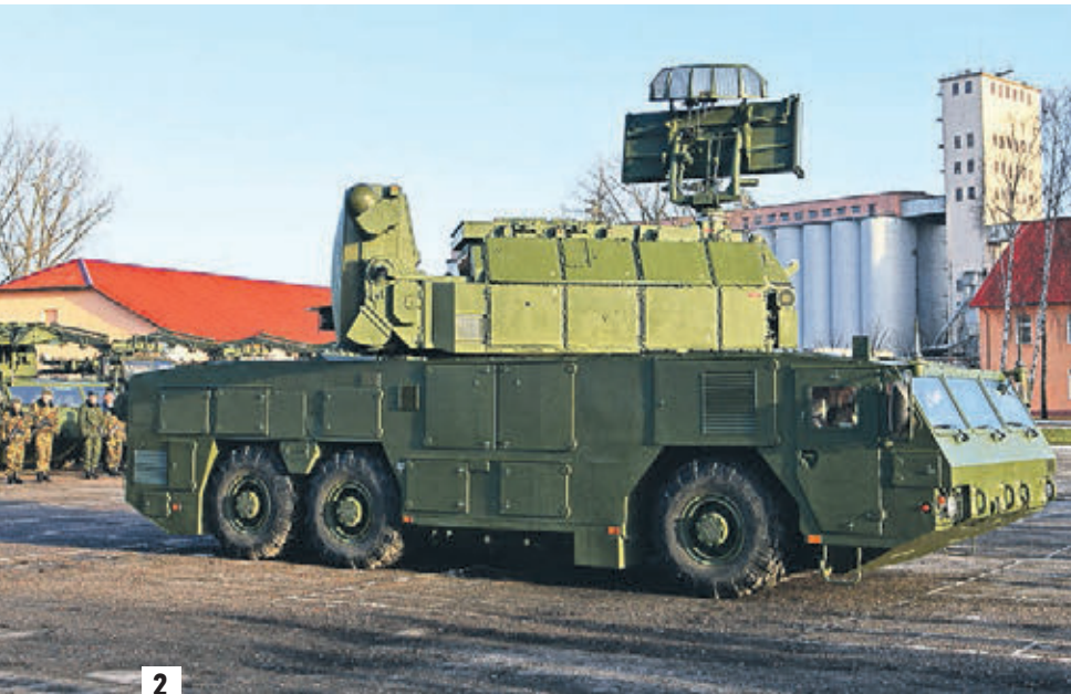
Барановичи, Белоруссия. Зенитно-ракетный комплекс «Тор-М2» на колесном шасси, принятый на вооружение 120-й зенитно-ракетной бригадой (2). Автономный боевой модуль 9А331 комплекса «Тор-М1» с зенитными ракетами малой дальности на гусеничном ходу меняет место дислокации во время учений (3)
