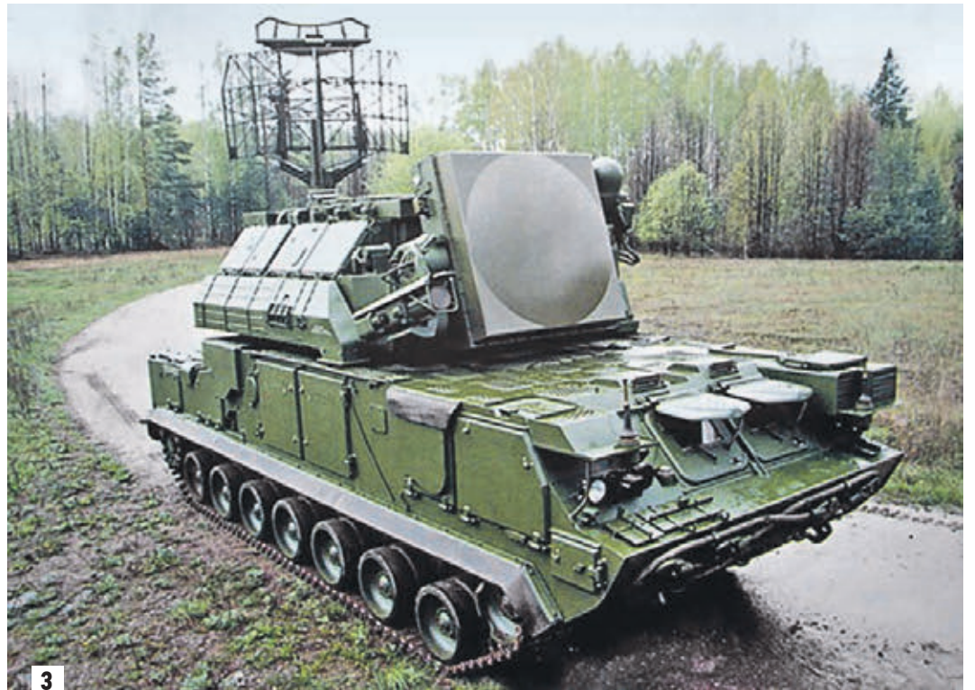
Барановичи, Белоруссия. Зенитно-ракетный комплекс «Тор-М2» на колесном шасси, принятый на вооружение 120-й зенитно-ракетной бригадой (2). Автономный боевой модуль 9А331 комплекса «Тор-М1» с зенитными ракетами малой дальности на гусеничном ходу меняет место дислокации во время учений (3)
