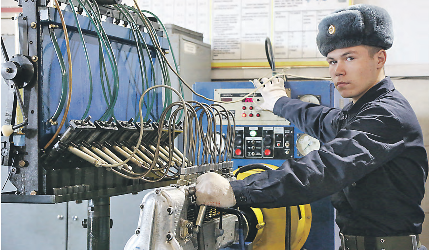
21 марта. Курсант Омского автобронетанкового инженерного института Никита Никитин работает за установкой, предназначенной для регулировки топливного насоса высокого давления и проверки его работы. Фото: Наталья Шатохина
