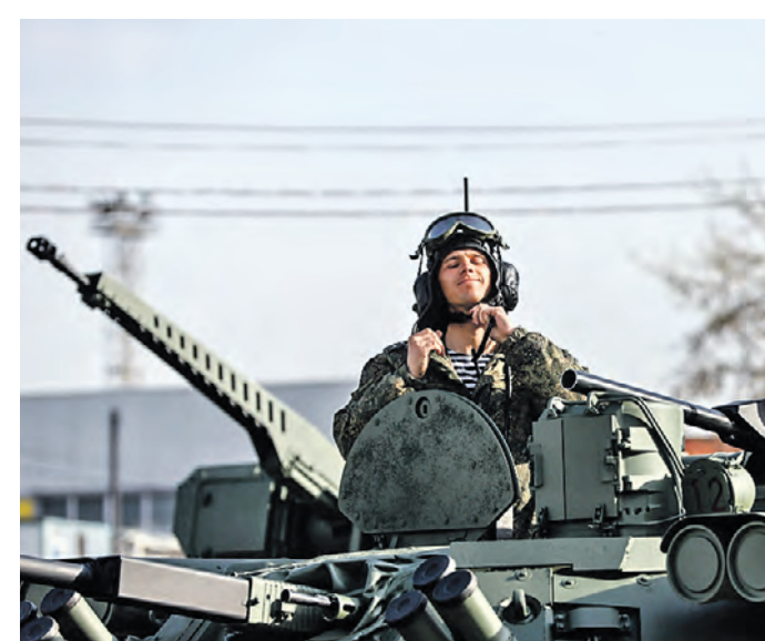
28 апреля 2022 года. Москва. Военнослужащий на боевой машине пехоты БМП-2М с боевым модулем «Бережок»
