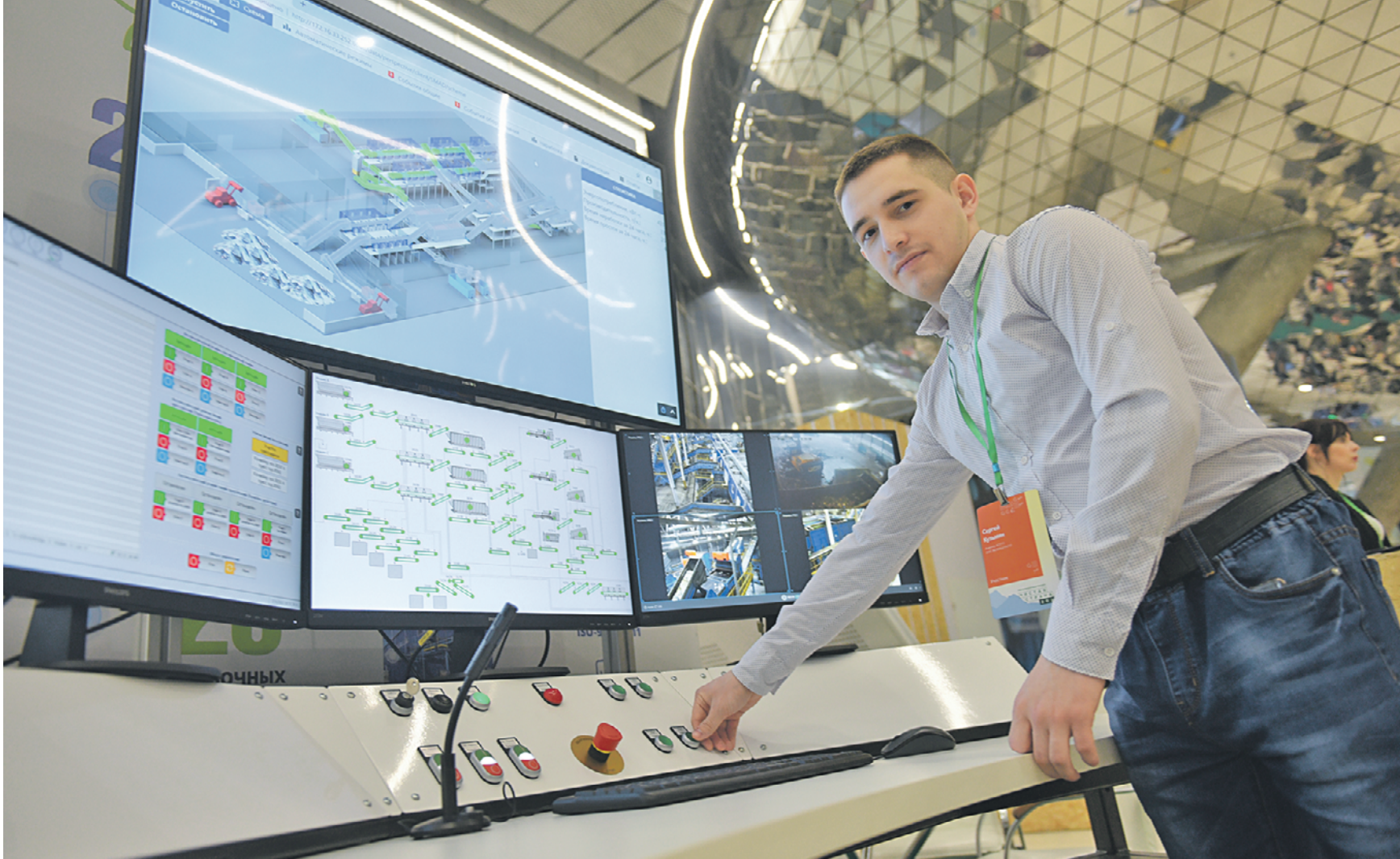
Вчера 10:48 Инженер компании-разработчика оборудования для переработки отходов Сергей Кузьмин демонстрирует панель, с помощью которой можно управлять мусоросортировочным комплексом дистанционно. Такая разработка существенно упростит работу специалистов отрасли
