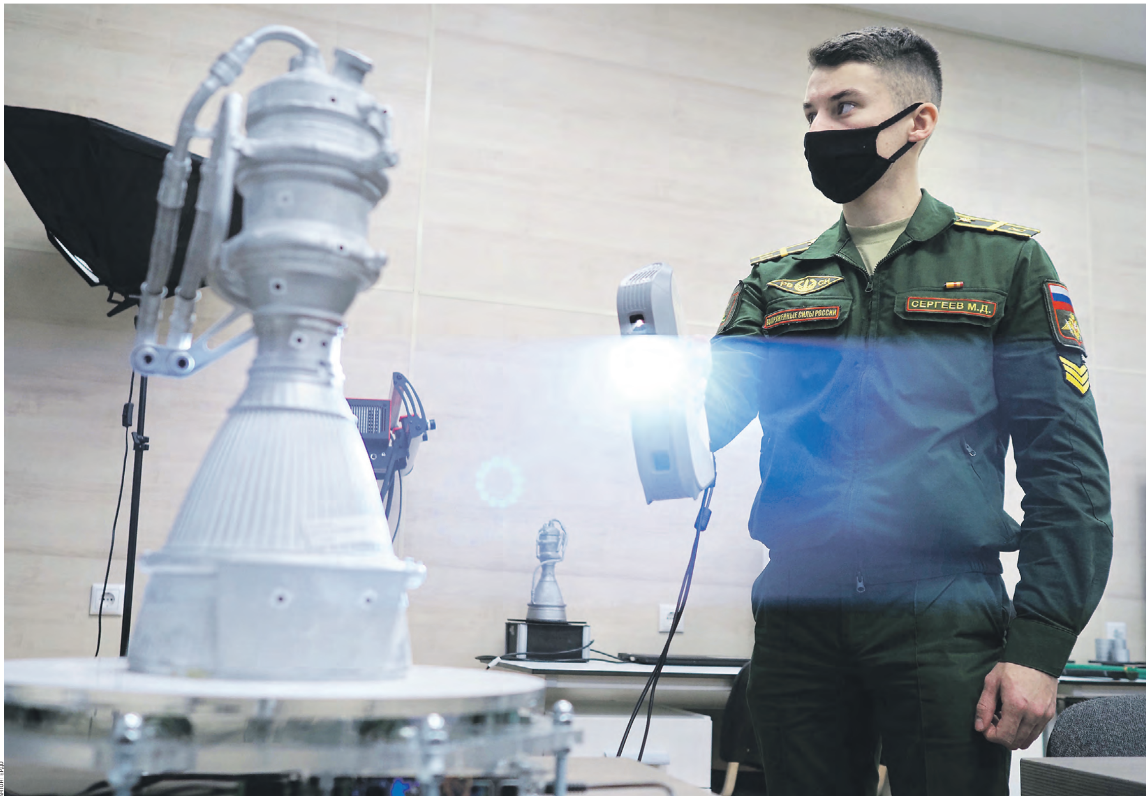
19 ноября 2020 года. Курсант Военной академии ракетных войск Михаил Сергеев сканирует двигатель для создания объемной модели
