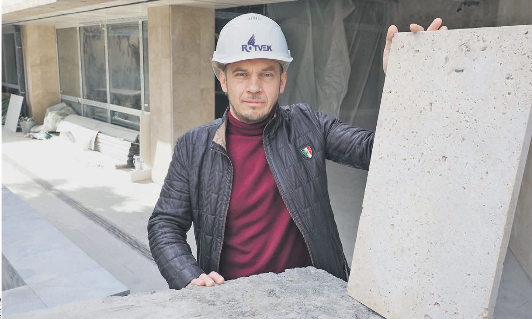
Вчера 13:41 Технический директор компании-подрядчика Олег Колотов показывает плиту из армянского травертина — это материал, которым изначально был облицован фасад павильона. При капитальном ремонте специалисты сохраняют оригинальную облицовку здания
