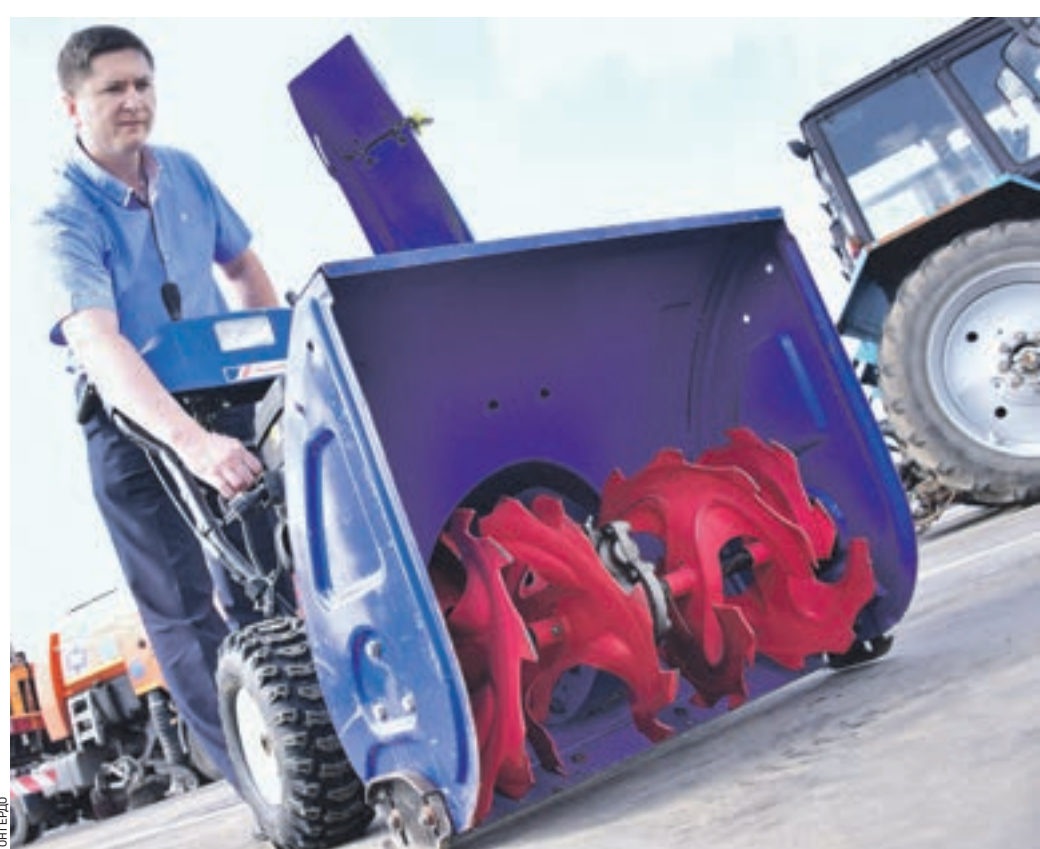
Вчера 11:05 В рамках подготовки к зимнему сезону глава управы Чертаново Северное Александр Демин проверил работу ручного снегоборозчика. Лопастями эта машина загребает снег, через трубу справа он равномерно укладывается на газон
