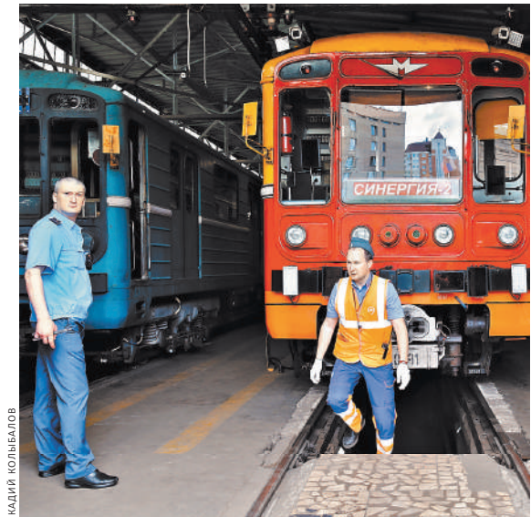
Поезд «Синергия» — это своеобразный аппарат МРТ для железнодорожных путей подземки.
