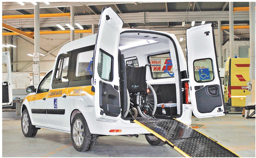
Спецверсию Largus оснастили складной аппаратурой, которая позволяет колясочнику легко заехать в автомобиль.
