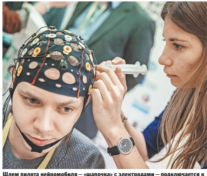
Шлем пилота нейромобиля — «шапочка» с электродами — подключается к искусственному интеллекту машины.
