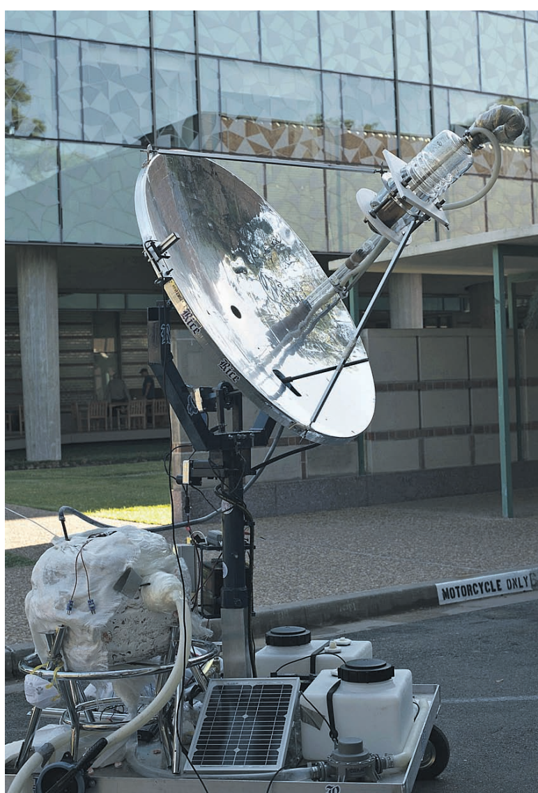
КПД передовой паровой установки составил 24%. Для сравнения, фотоэлектрические панели солнечных батарей обладают КПД 15%
