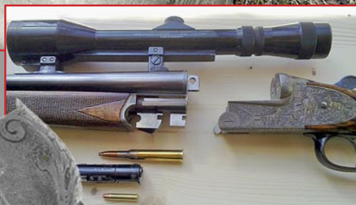
Drilling «Франц Зодиа» (Franz Sodja). Калибры: 16/70, 16/70, 7x65R, вкладной ствол «Кругхоф» .22 WMR., 40 см
