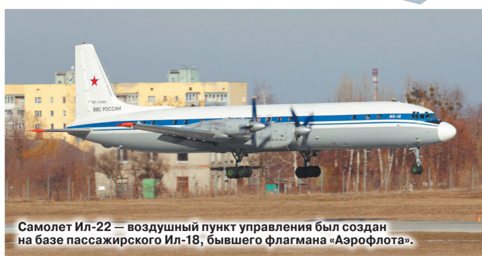
Самолет Ил-22 — воздушный пункт управления был создан на базе пассажирского Ил-18, бывшего флагмана «Аэрофлота».
