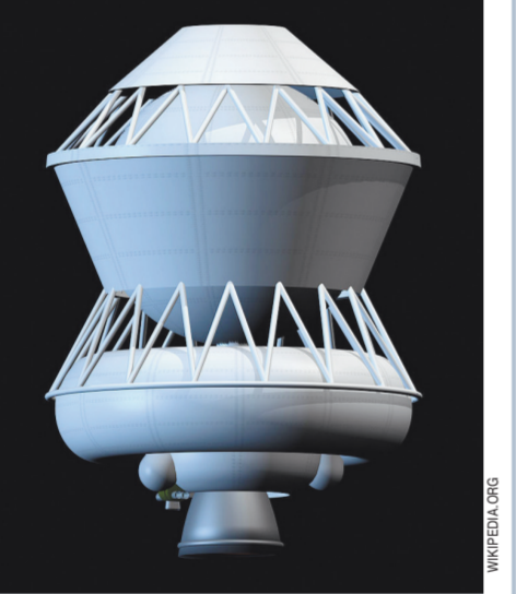
Разгонный блок Д, на основе которого создан «Персей».
