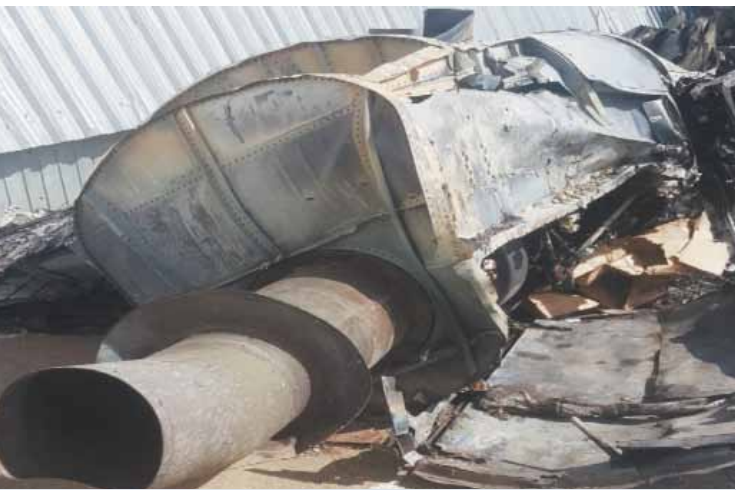
Один из задних отсеков фюзеляжа сгорел полностью, уцелели только детали из титановых сплавов и сталей.
