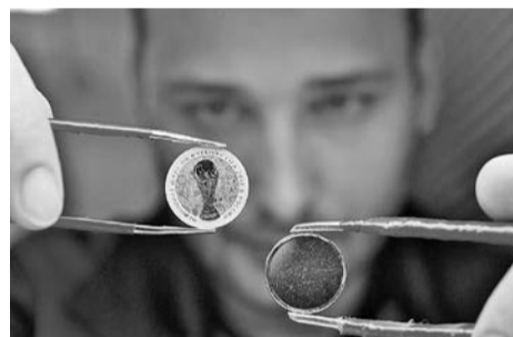
Вот из такой заготовки (справа) после процесса чеканки появляется готовая монета стоимостью 40 тысяч рублей.
