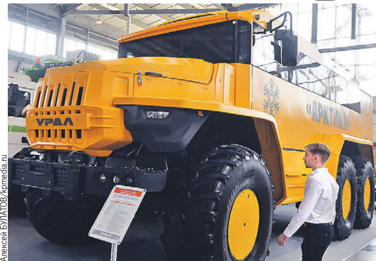
Завод «Урал» представил новую модель автобуса на базе грузовика. Внутри есть система вентиляции и обогрева, климат-контроль и биотуалет.
