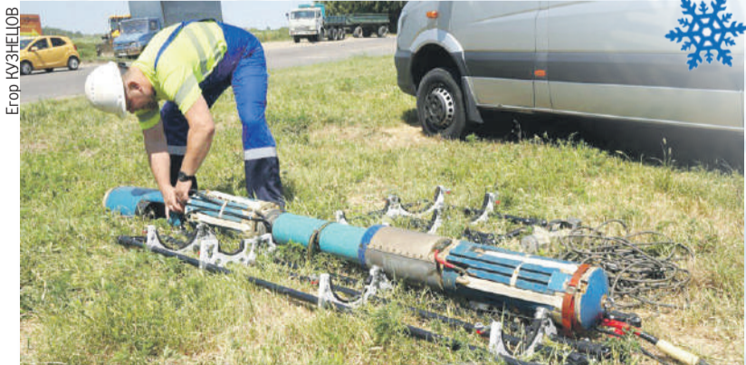
Этот робот «плавал» по теплосетям Краснодара, изучая их изнутри и снимая все на камеру: это и есть внутритрубная диагностика.
