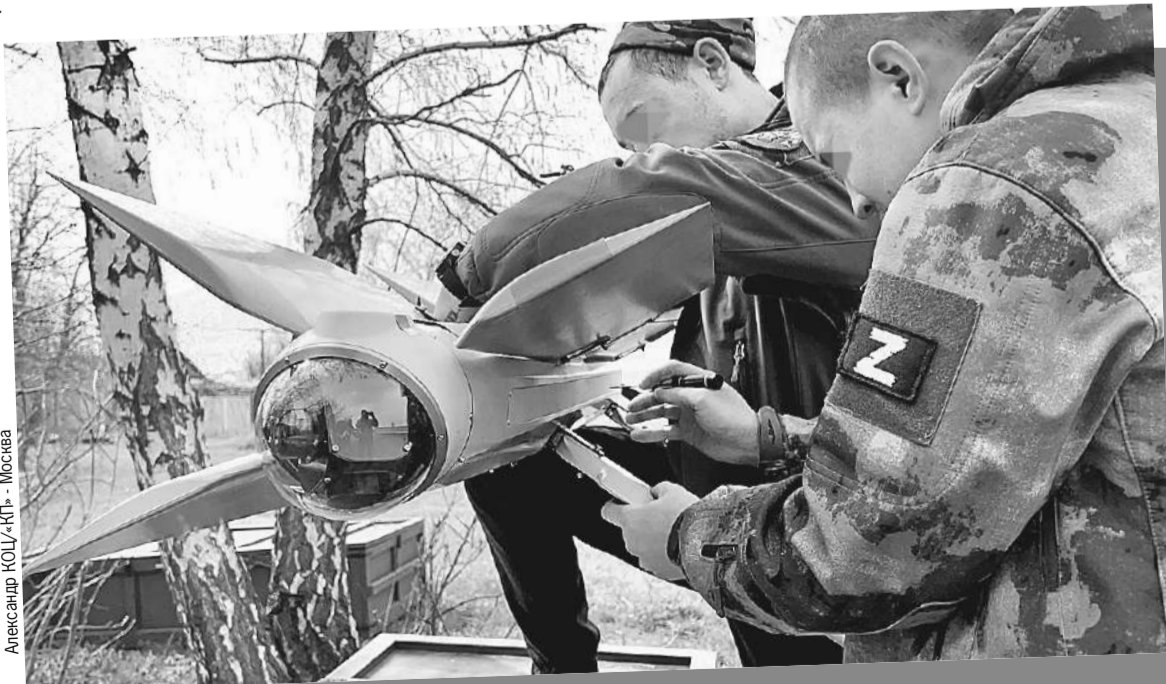
Настоящий хит СВО - наш барражирующий боеприпас «Ланцет». Украинские радары принимают его за птицу за счет крыльев, расположенных буквой Х.
