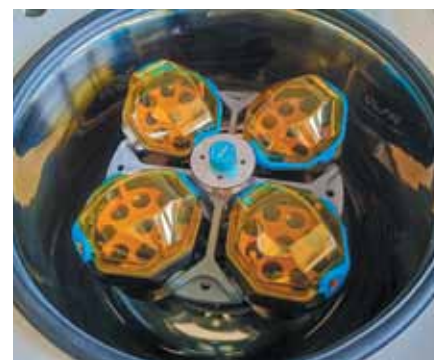
Центрифуга с ротором. Предназначена для разделения фракций различной плотности в химических, биохимических, промышленных и учебных лабораториях.
