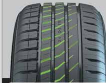
В центральной части протектора расположены перьевые канавки, направляющие поток воды от центра к внутреннему «плечу».
